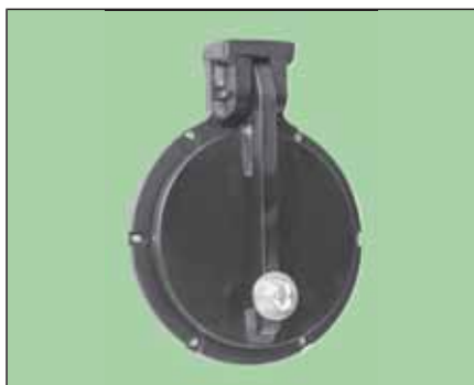
VAG HADE® Обратный клапан PTK-G Сточные воды PN 0,5 - Ду (DN) 150...1000
