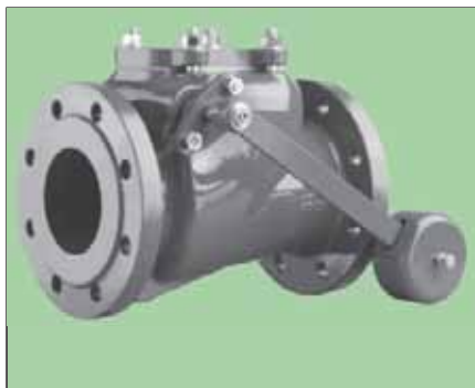
VAG RSK Обратный клапан AL Вода PN 10/16 - Ду (DN) 40...250 металлическое уплотнение - с рычагом и противовесом
