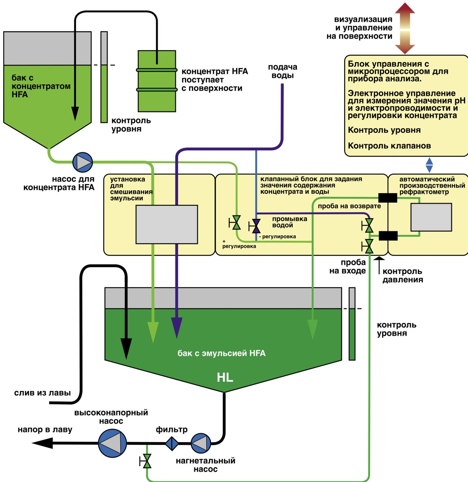
Высоконапорная насосная станция, состоящая из высоконапорного насосного агрегата, резервуаров концентрата и эмульсии, фильтровальной станции и установки смешивания эмульсии
