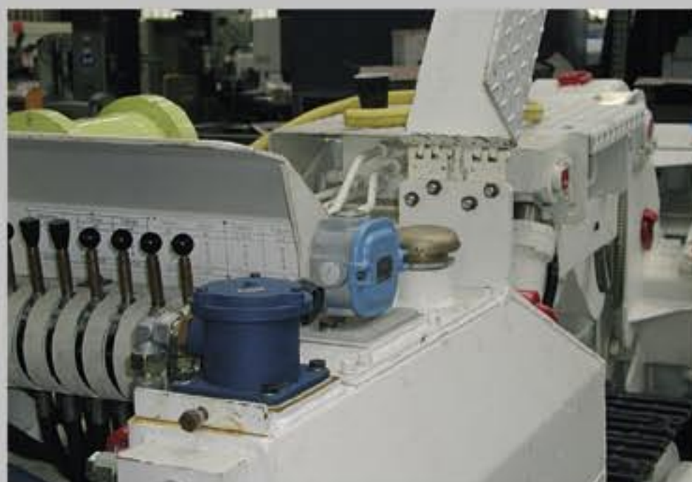
Контроль за наполнением бака погрузочной машины гидравлической жидкостью
